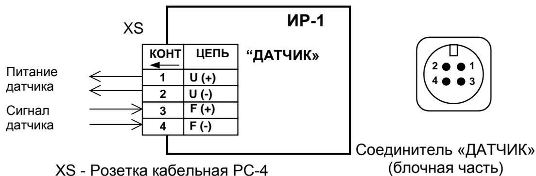
Рис.2. Подключения к ИР датчика ДРС.М
